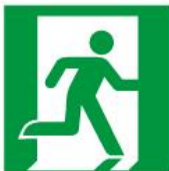
E002 Salida de emergencia (a la derecha)
